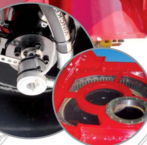
Rotação contínua e ilimitada, com redutor de rotação de 2 etapas e travão negativo integrado com banho a óleo.
