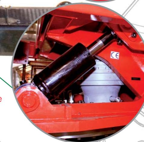
Equipada com 2 cilindros hidráulicos que controlam a inclinação da compactadora nas zonas mais acentuadas.
